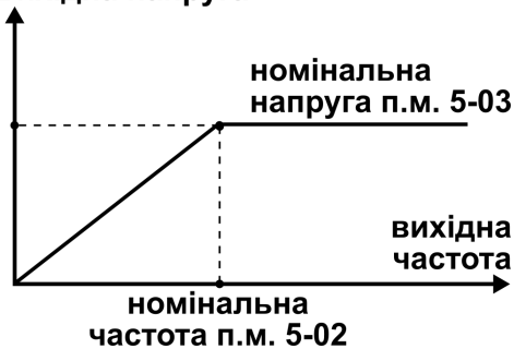
Рисунок 20. Залежність між номінальною частотою двигуна і його номінальною напругою.
