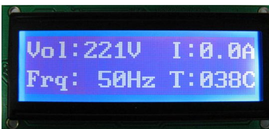
图 8.8c EG8010 连接 12832 工作时液晶屏显示信息
